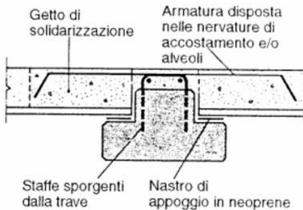
Esempio di collegamento trave – solaio di piano
